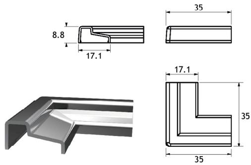
Elemento di giunzione a 90° per profilo di contenimento IPD02
