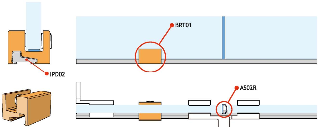
BERT è un piccolo sistema che, grazie alla diga a basso profilo IPD02, i morsetti per vetro fisso BRT01 e la speciale guarnizione adesiva AS02R, consente la realizzazione di cabine doccia con apertura a battente a perfetta tenuta
